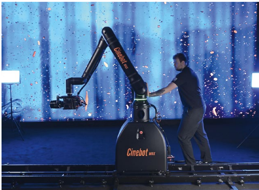
Le robot Cinebot Max de MRMC supporte une charge maximale de 20 kg et une hauteur de caméra de 3,2 m.
