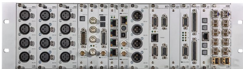
L'architecture modulaire de la matrice Nexus facilite son évolution vers les nouveaux formats d'audio numérique. © Stagetec
