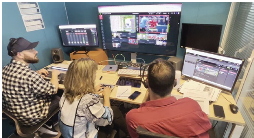
Capture d'image de la régie de prod dans le cloud à France TV. Des pupitres de contrôle remplacent l'utilisation du clavier et de la souris. Les équipes accèdent aux interfaces Web via des ordinateurs (portable, Mac mini, etc.). © France Télévisions
