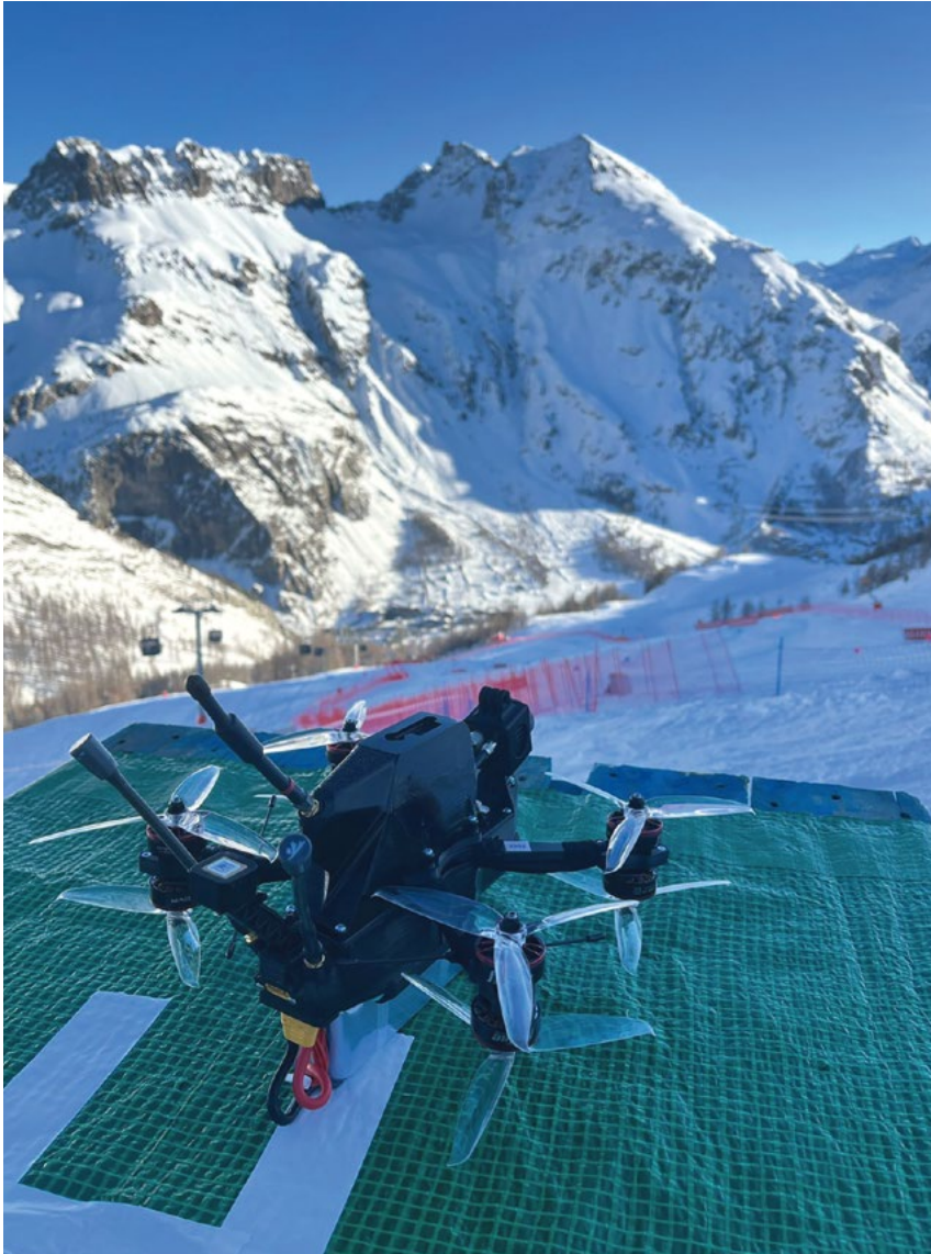
Les drones sont conçus pour chaque configuration de prise de vue et de live, et transportent un système émetteur pour envoyer le flux vidéo à la régie. © Menga FPV
