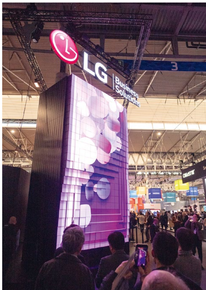
LG présente un impressionnant mur Led déformable, composé de dalles qui peuvent se mouvoir perpendiculairement à l'écran. © Luc Bara
