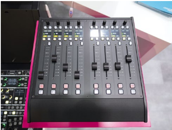
Lawo présente Crystal, sa nouvelle petite console audio aux applications multiples : extension de consoles mc2, télécommande du Power Core ou mini console autonome. © Luc Bara
