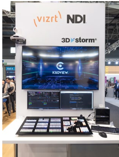
Chez 3D Storm, la nouvelle panneau Dual Flex de Vizrt est capable de piloter n'importe quel Tricaster du réseau. © Luc Bara
