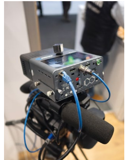
Le nouveau boîtier Kiloview P3 du stand 3D Storm peut encoder un flux vidéo et agréger quatre réseaux 5G pour le transmettre. © Luc Bara
