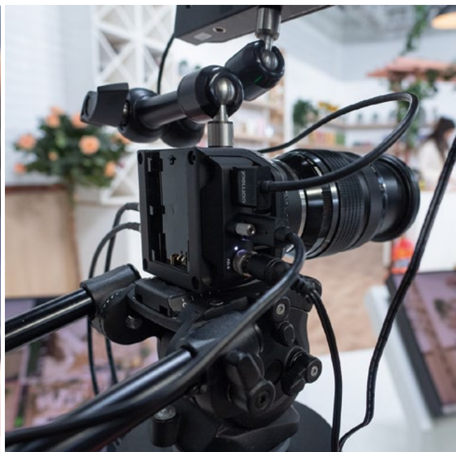
Blackmagic présente sa nouvelle Micro Studio Camera 4K G2 en micro 4/3, capable d'enregistrer en BMD RAW sur un disque externe connecté en USB. © Luc Bara
