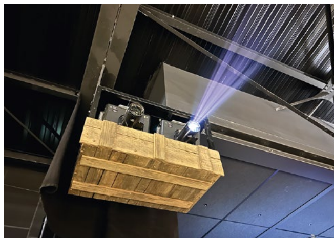
Quatre projecteurs laser Digital Projection Satellite MLS Insight 4K de 20 000 lumens installés en binôme au fond de la salle de spectacle.
